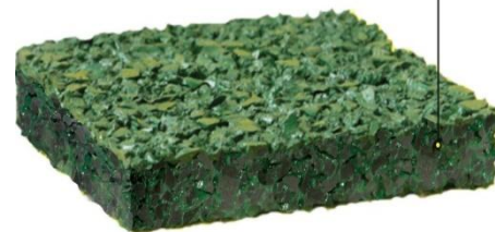
окрашенная резиновая крошка с полиуретановым связующим
