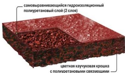
✓ высокопрочное наливное полиуретановое покрытие, производимое из резиновой крошки, с нанесением на поверхности двух слоев полиуретанового компонента. Применимо для любых поверхностей, которые подвержены большим нагрузкам, часто эксплуатируются, а также, где необходимо обеспечить дополнительную гидро-, шумо- и теплоизоляцию.
