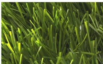
Искусственная трава из монофиламентного волокна, H ворса = 60 мм. Данная система искусственного газона схожа с травой натуральной, состоит из тафтингового сочетания термостабилизированного монофиламентного полиэтилена на латексной основе.
