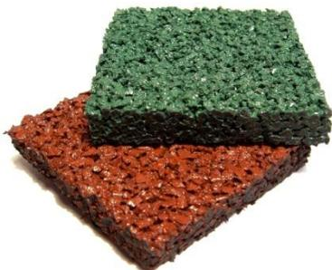
✓ Однослойное бесшовное наливное полиуретановое покрытие, для детских площадок, пешеходных дорожек и зон отдыха. Производится методом наливных полов из резиновой крошки и полиуретанового связующего, толщиной 10-15 мм, с возможностью нанесения цветных изображений и логотипов.
